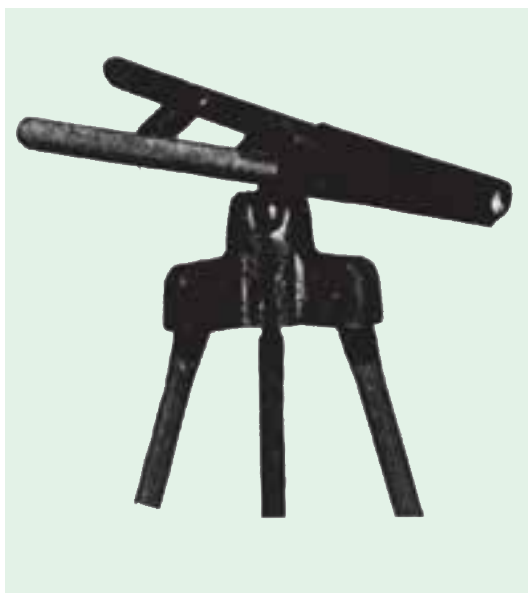
شکل ۳-۳ ژالون گیر و نحوه‌ی به کارگیری آن
