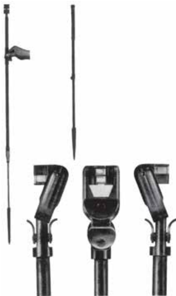
شکل ۸-۳- گونیای منشوری و پایه‌ی مخصوص آن
