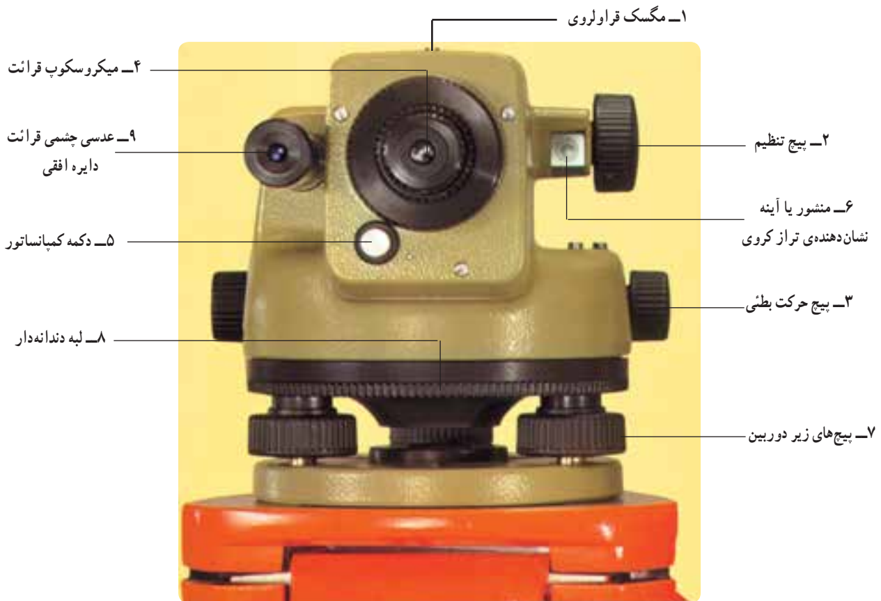
شکل ۸-۹- قسمت‌های ظاهری یک تراز یاب
