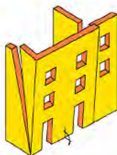
شکست درون صفحه ای شکست خارج از صفحه
