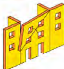
واژگونی و شکست جزئی از دیوار
