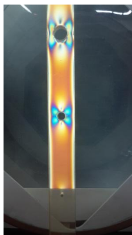
شکل ۱۱: هاله‌ی ایجاد شده در قطعه پس از اعمال بارگذاری در یکی از حالات آزمایش
