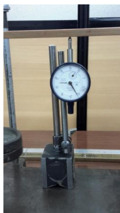
شکل ۸: ساعت مورد استفاده برای تحقیق اصل دوطرفه‌ی ماکسول
