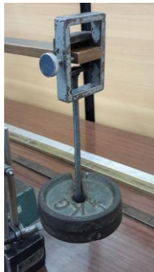
شکل ۹: آویز اعمال بار و بست مورد استفاده برای تثبیت آن
