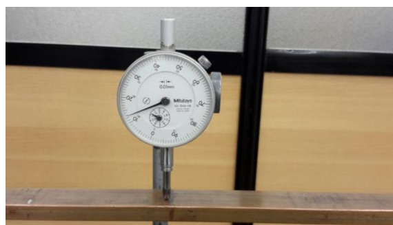
شکل ۶: ساعت موجود بر روی فونداسیون دستگاه انجام آزمایش برای تعیین میزان جابجایی وسط تیر
