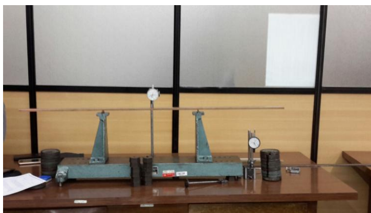
شکل ۵: فونداسیون دستگاه انجام آزمایش
